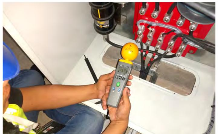
Electromog: Medición de parámetros radiados de campo electromagnético del producto FG-PROCAR-2000A, aplicando la normativa 92 del International Electrical Commission (IEC). Resultado de la prueba: Aprobado.
